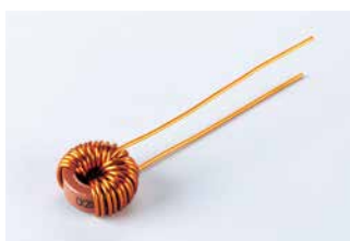
トロイダルコイル ノイズ取りに使用されます。
