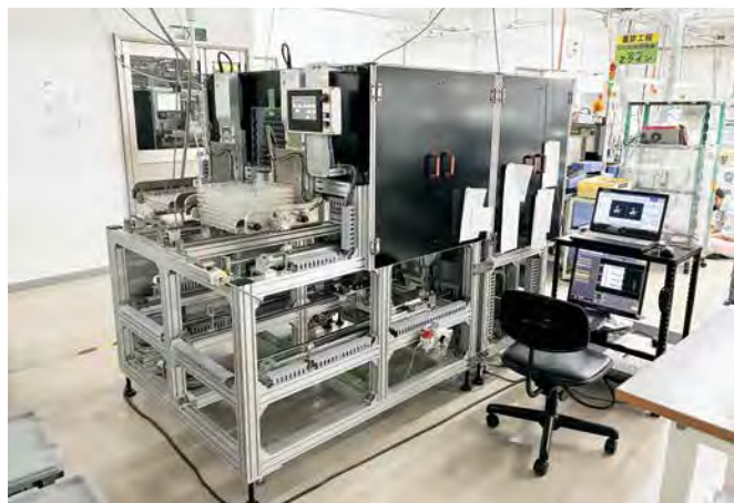
ピックアップコイル ボビン成形から巻線半田加工が可能です。
